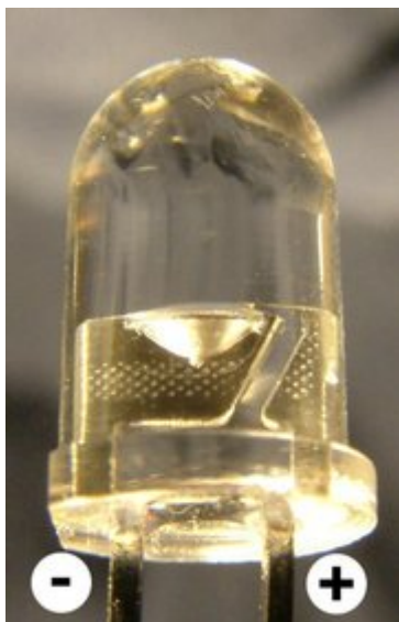
Makroaufnahme einer Leuchtdiode (Durchmesser 5 mm).
